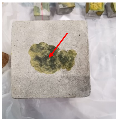
Рис. 10. Окраска универсального индикатора на поверхности карб. кубика 10 \times 10 \times 10 см с добавкой нитрита натрия. Окраска говорит о 10,5 < \text{pH} \leq 11
